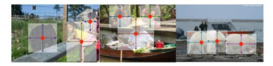
基于高斯核中心,预测目标的长和宽。详细说明请阅读参考文献[3]。CenterNet 提出了一种新颖目标检测框架和 Loss 函数,为了实现目标检测,本工程采用 Yu, Fisher 等人提出的
