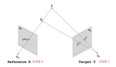
理想情况下,双目系统左右相机的焦平面位于同一平面,并且焦点在水平方向上是对齐的。如下图所示:
