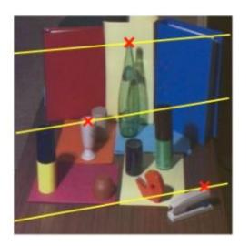
两路摄像头的焦距不能落到同一个平面上,其光路图图下图,这种存在一定偏角的相机安装 方式将导致立体匹配的计算量激增和无法用三角形相似来计算出深度信息。
