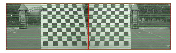
当两个摄像头极线几何后,左右图像的物体在水平位置上是对齐的。此时,根据就可以在同一水平线上匹配左右图像的特征点得到视差图,本工程参考由学者 Hirschmüller 在 2005 年所提出的 sgm 方法<sup>[2].</sup>
