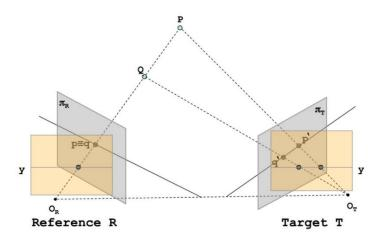
为了将消除安装相机直接的偏角,需要对左右相机做极线几何,将左右图像重新 remap 到新的像素位置以实现极线几何,同时需要再裁剪出左右相机最佳匹配的像素区域。工程参考 Zhang Z.等人提出的方法<sup>[1]</sup>对左右 images 做极线几何,对左右图像做了极线几何的效果如下图
