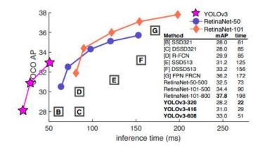
本工程基于 yolo-v3 设计了障碍物,并将训练的模型部署到 nvidia AGX xavier 上,在 nvidia AGX xavier 上测试的运行速度可达到 20fps 左右。
